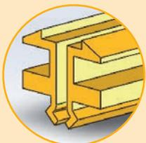
Profil A.M.O. zwecks Montage von Stahlmodulen oder Polymix-Modulen auf der MGI-Basis
