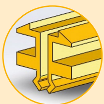
Profil A.M.O. pentru montarea modulului din oțel sau polimixt pe baza MGI
